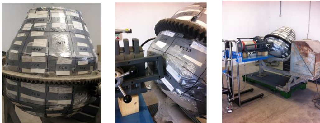
Figura 6.6. Imagen final de la hormigonera con las fuentes y medida con equipo ISOCS.
