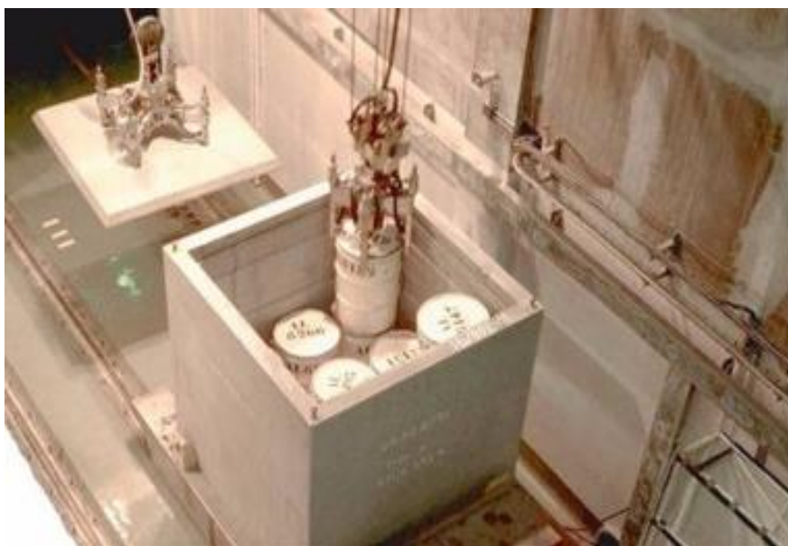
Figura 1.2. Almacenamiento de bultos en los contenedores de hormigón finales en las celdas RBMA
