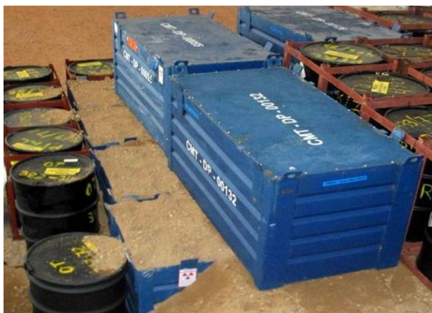
Figura 1.3. Almacenamiento de contenedores RBBA en la celda de muy baja.
